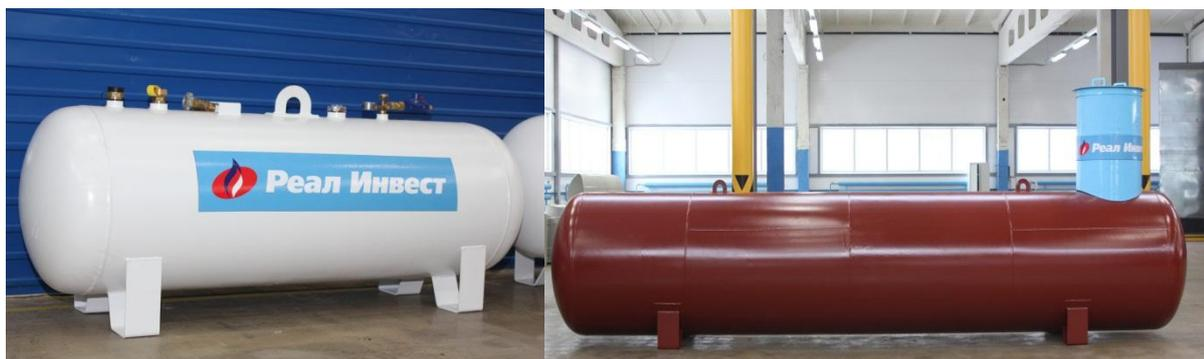
Газгольдеры произведены на современном высокотехнологичном оборудовании. Для производства использована сталь 09Г2С-12, толщина 6 мм. Сварные швы обечайки к донышкам выполняются с нахлестом, методом сварки-наплавки сварочным автоматом под порошковым флюсом (SAW) и соответствуют ГОСТ 8713-79.
