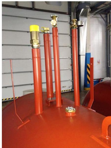
**Антикоррозийное покрытие** производится после дробеструйной обработки **многокомпонентной грунт-эмалью** устойчивой к агрессивным средам.
